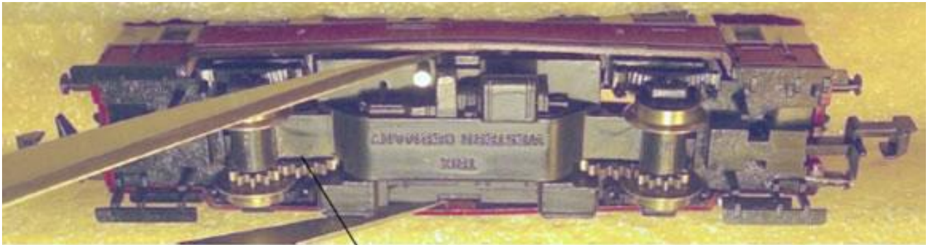
In Fahrtrichtung rechts Masse
